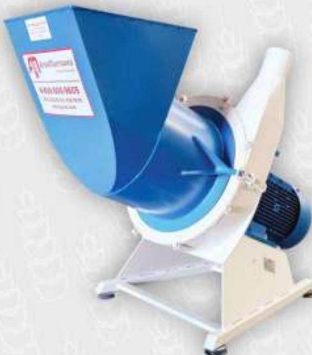
Измельчитель ДПМС предназначен для измельчения соломы, сена влажностью до 15%.
