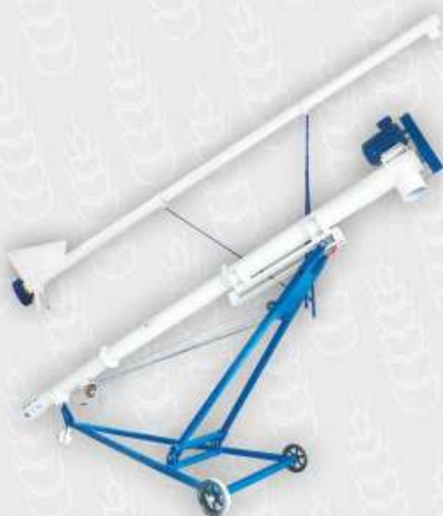
Транспортер секционный шнековый – оборудование непрерывного действия, предназначенное для транспортировки насыпных материалов зернистой и мучнистой консистенции с размером частиц до 30мм (содержание частиц размером до 30мм не более 10%), удельным весом до 850 кг/м<sup>3</sup>, влажностью до 14%.
