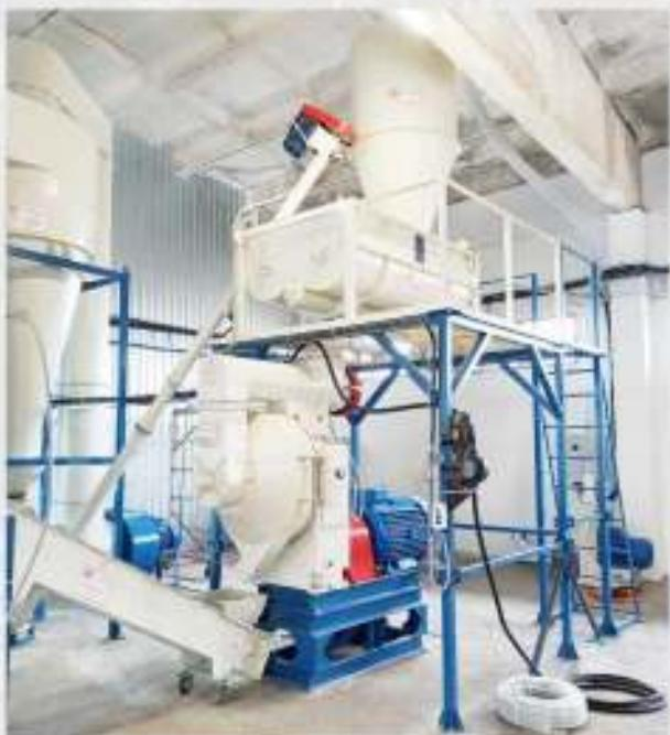
Пресс-грануляторы серии ОГМ предназначены для производствагранулиз трудногранулируемого сырья: опила, соломы, травяной муки, отрубей, лузги, барды, торфа, органоминеральных удобрений, а также комбикормов и т.д.
