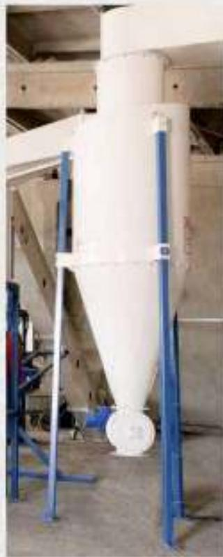
Циклон ЦОЛ в составе линии гранулирования
