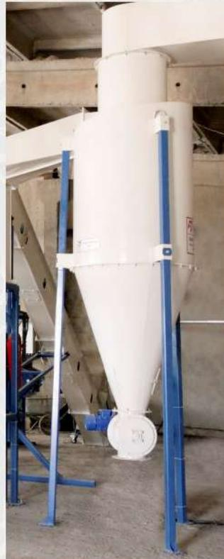
Циклон ЦОЛ в составе линии гранулирования
