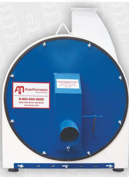
**Дробилка предназначена для пневматического забора, измельчения и транспортировки к месту выгрузки зерновых, бобовых культур, жмыхи и шрота (мелкая фракция).**
