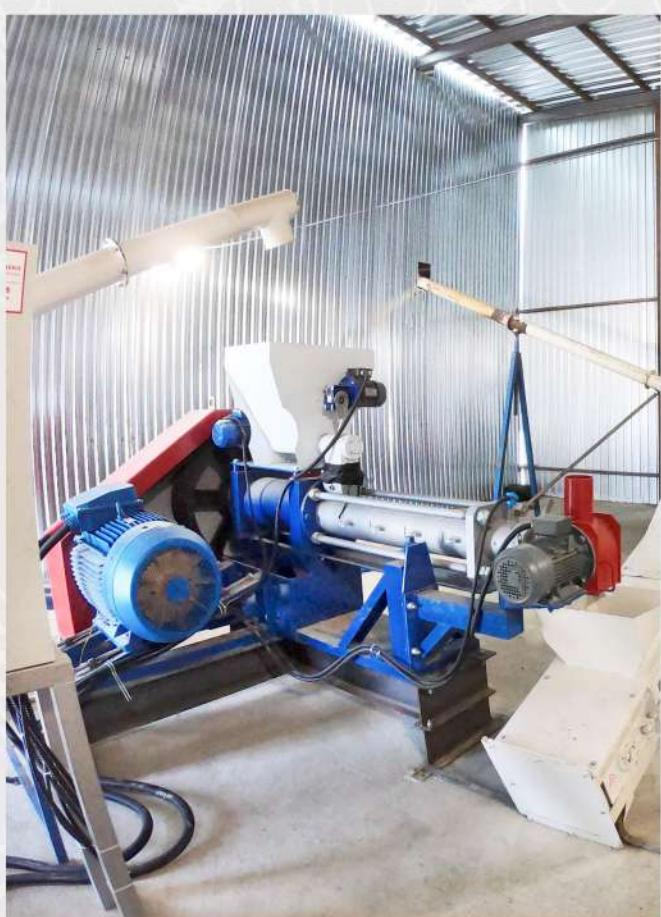
Экструдер серии «ЭМ» предназначен для производства кормов путем экструдирования: пшеницы, ржи, ячменя, кукурузы, гороха, сои, а также смеси отходов животного происхождения с зерновыми и мясокостной муки.
