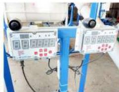
Измерительный терминал ДУЭТ
