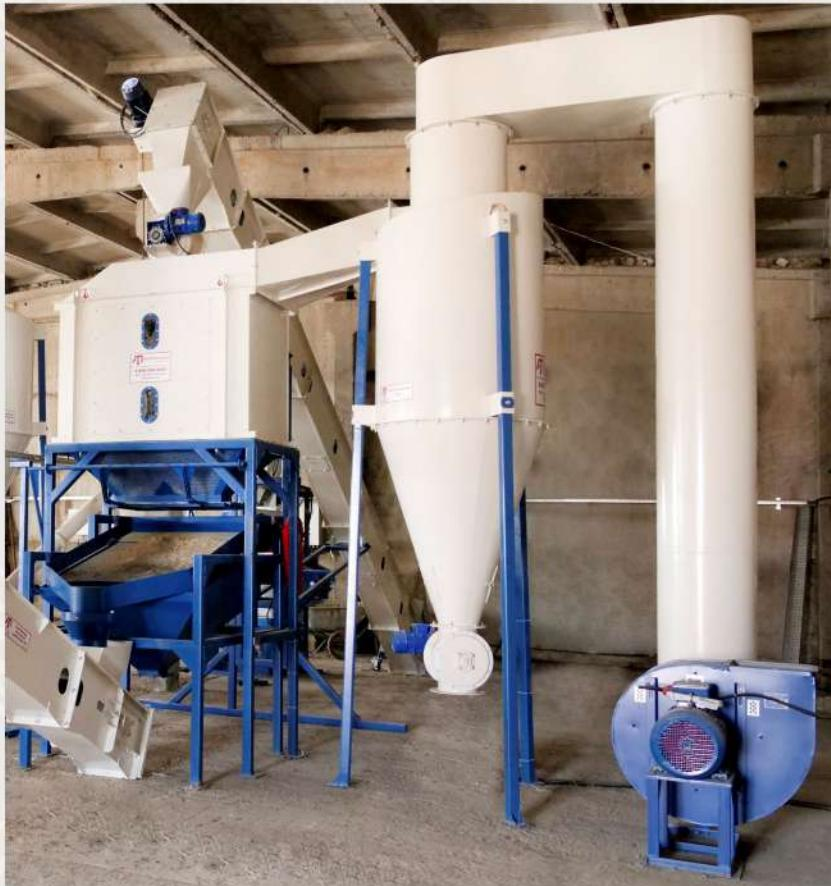
Колонна охлаждения применяется для охлаждения гранул и для отделения не гранулированной массы в технологических линиях гранулирования.
