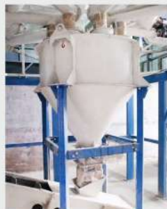
Весовой бункер с тензодатчиками
